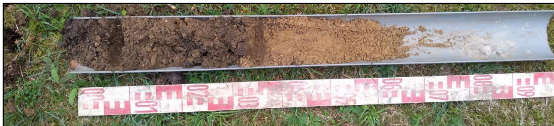
Afbeelding 12: Boring 3, deelgebied 2 met achtereenvolgens het gras, de Ap1- en de C-horizont
