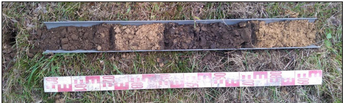
Afbeelding 11: Boring 6, deelgebied 1, met achtereenvolgens de Ap1-, Ap2, A1- en C-horizont
